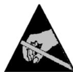
**Внимание:** электронные компоненты системы управления пароувлажнителя воздуха HygroMatik очень чувствительны к электростатическим разрядам. Для защиты этих компонентов при проведении всех монтажных работ должны быть приняты меры против повреждения устройства электростатическими разрядами.
